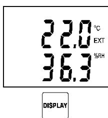
Na horním řádku displeje se zobrazuje teplota vzduchu ( $^{\circ}\text{C}$  EXT), na dolním řádku relativní vlhkost vzduchu (%RH). Tyto údaje jsou z externí sondy.
