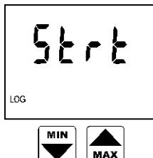
První nabídkou je START/STOP záznamu. Tato položka je ve dvou variantách: je-li záznam zastaven, nabízí se spuštění záznamu (symbol Strt = START), je-li naopak záznam už spuštěn, nabízí se zastavení záznamu (nápis STOP). Potvrzení (obou variant) této volby se provádí kl. ENTER. Upozornění: je-li indikována slabá baterie, nelze záznam spustit.
