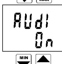
Indikuje zapnutí (On) nebo vypnutí (OFF) akustické signalizace překročení hranic alarmů. Stiskem klávesy ENTER lze aktuální stav změnit v opačný. Upozornění: je-li baterie už slabá, akustická signalizace z důvodu omezení odběru proudu nepracuje a to nezávisle na nastavení této volby.
