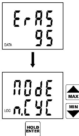
Tím je spuštěna procedura mazání, její průběh je indikován na displeji průběžným zobrazením procentuální hodnoty velikosti už vymazané paměti (číslicemi 0 až 100).
