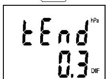
Jako poslední se zobrazuje hodnota tlakové tendence (hPa), která představuje rozdíl tlaku aktuálního a tlaku před 3 hodinami. Jestliže není přístroj zapnutý alespoň 3 h, není hodnota tlakové tendence ještě dostupná a na displeji jsou zobrazeny pomlčky (--).
