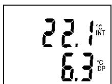
Přístroj poté zobrazuje teplotu okolí přístroje měřenou vnitřním senzorem (symbol INT) a teplotu rosného bodu vypočtenou z údajů externí sondy (rádek označený symbolem DP).
